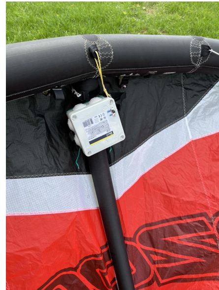
(b) Mise en place du boîtier de capteurs
