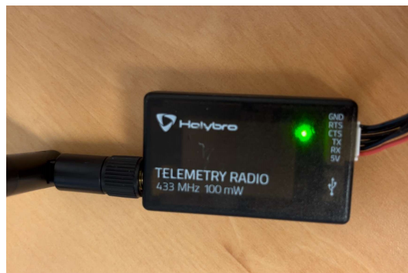
FIGURE 3.18 – Module de télémétrie connecté à l'autre module pour échanger les données
