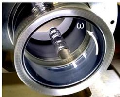
Figure 1: Cavitité cylindrique d'air dans un écoulement en rotation solide
