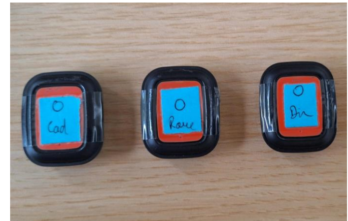
Capteur IMU : Inertial Central Unit (IMU) accéléromètre et gyroscope
