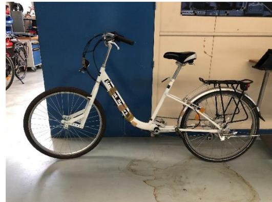
Figure 2 : Vélo expérimental avec la possibilité de modifier la position de la roue avant pour changer des caractéristiques géométriques.
