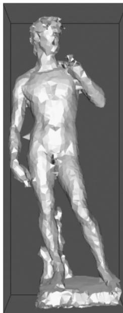
(a) Surface reconstruite avec un faible échantillonnage
